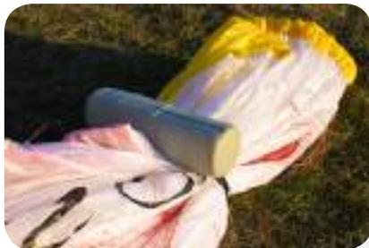
**Etape 5.** Placez le coussin pliant derrière le bord d'attaque. Ceci diminue l'angle des plis et aide à la conservation des renforts. Repliez ensuite le bord de fuite autour du bord d'attaque en évitant autant que possible un pliage trop serré.
